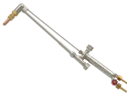
A号切断器Zノバック 中形切断器よりも大型で 厚板の切断が可能
