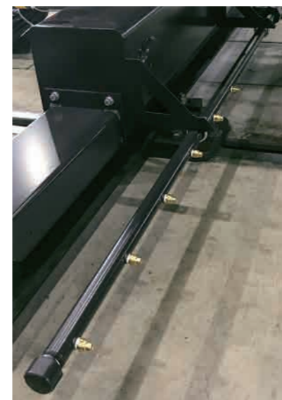
ヒュームブロー装置
