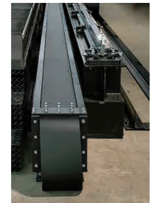
H鋼架台走行レール
