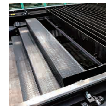
歩廊階段付き切断定盤
