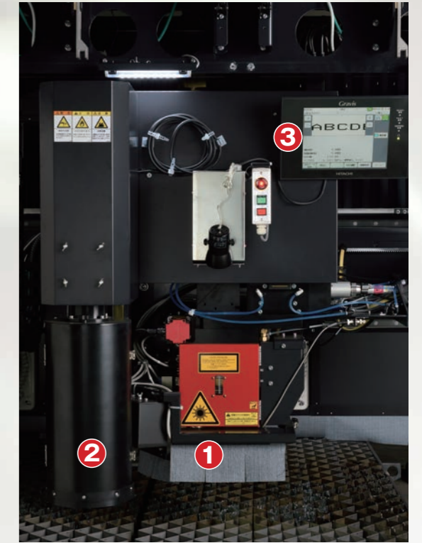
i-マーキング装置搭載時切断トーチ ① 切断トーチ ② i-マーキングトーチ (防塵カバー付き) ③ i-マーキング操作パネル ※写真は日立産機システム製です
