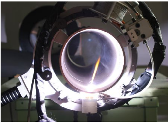
プラズマ溶接施工状況
